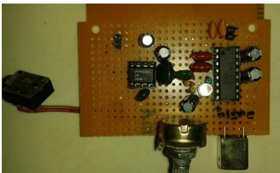
**Gambar 15. PCB Rangkaian OP-AMP IC LM386 dan IF IC LA1260**
